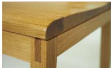
Schlitz- und Zapfenverbindung und Schattenfuge
